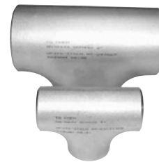
Ταφ κολλητά ASTM A403-2000B/ ASME SA403-1992/ANSI B16.9-1993, Ανοξείδωτα AISI 316L. Πιστοποίηση κατά Din 50049/3.1B
